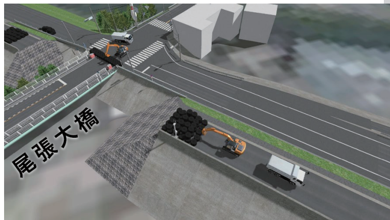
図-4 仮想空間を利用した大型土嚢の設置訓練 (イメージ)
