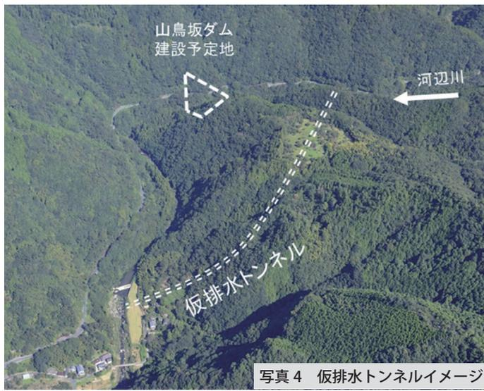
さらに、今後のダム本体工事に向けて、令和5年度に着手した延長約682mの仮排水トンネル（転流工）工事の進捗を図っています。
