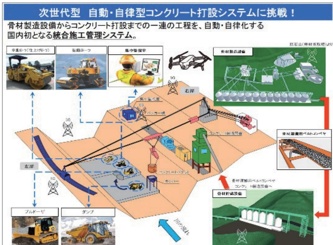
図-3 自動・自律型コンクリート打設システム
