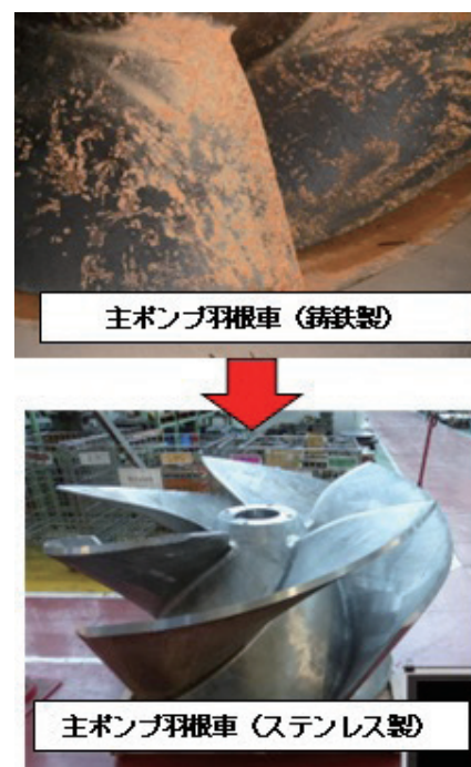
図4 ポンプ羽根車の更新
